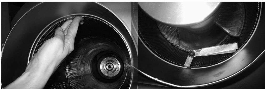
Fig. 13-13 : Tamis flottant dans le séparateur, vérification manuelle (à gauche)
