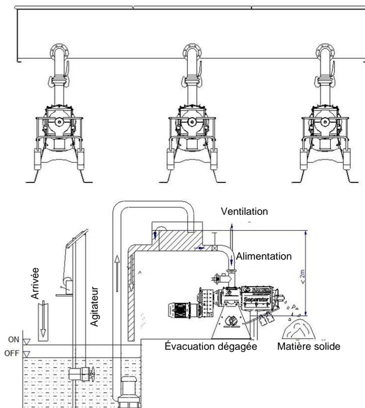
Fig. 9-1. Disposition typique de 3 séparateurs utilisés en parallèle
